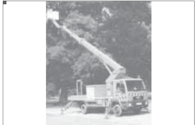
INSTALAR, MONTAR Y SUPERVISAR UNA PLATAFORMA ELEVADORA MÓVIL DE PERSONAL (PEMP) Y SU CESTA
